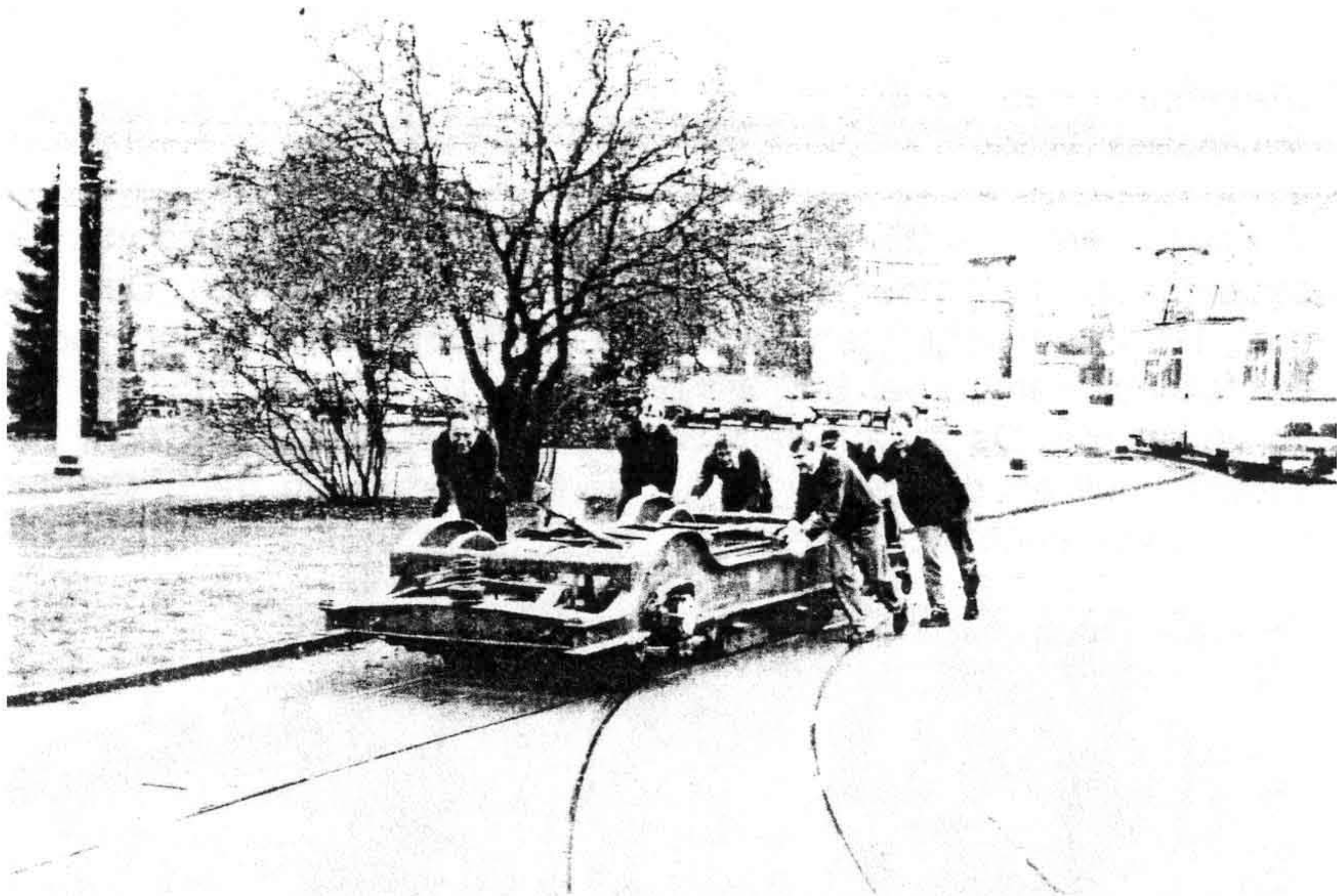
Vereinsmitglieder beim Umsetzen des Fahrgestells des ehem. Tw 162
